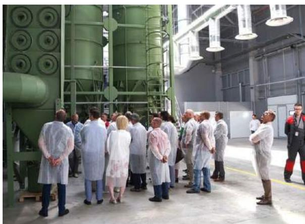
Особое внимание было обращено на устройство очистных сооружений воды и воздуха: продемонстрированы хеппа-фильтры и система очистки воды, отмечено, что срок службы хеппа-фильтров составляет от одного года до полутора лет, после чего, необходимость замены фильтра обусловлена не только экологической составляющей, но и производственной, т.к. при ухудшении характеристик очистных, производительность предприятия снижается, что не выгодно заводу и с экономической точки зрения.
